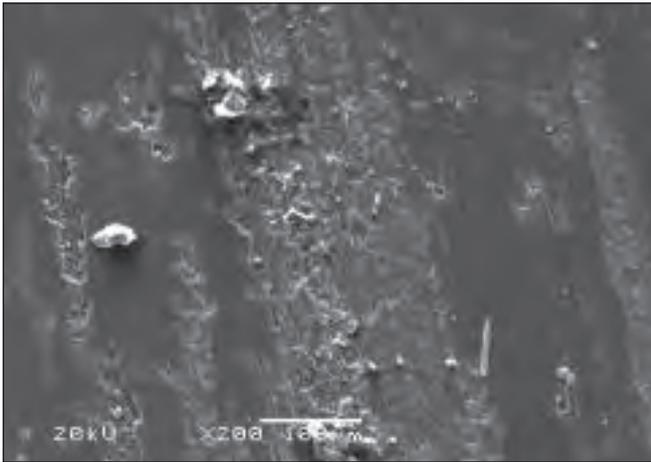
(d) 3.0% TiO<sub>2</sub> + CF/EP under load of 200N
