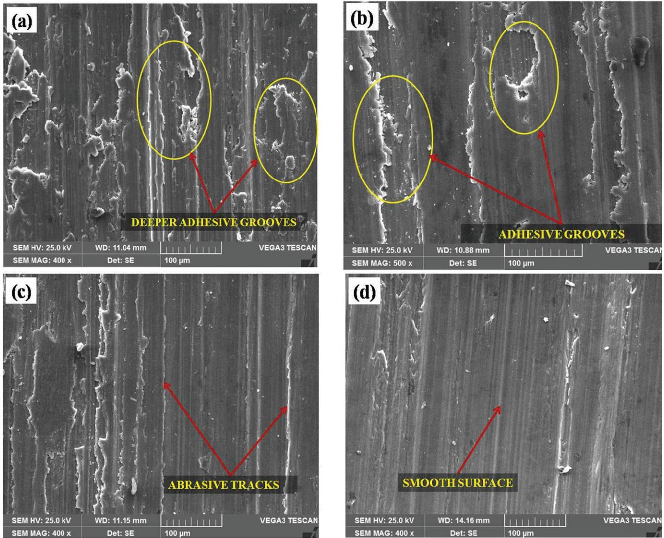
**Figure 9** (a-d): Worn surface SEM images of (a) ascast 7075Al, (b) 7075Al +6wt.% WC-Co Composite, (c) 7075Al +9wt.% WC-Co Composite and (d) 7075Al +12wt.% WC-Co Composite
